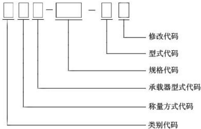
示例：动静两用电子汽车衡，量程 100t，则代号为：Z/FSG—100—DJ，即：类别：自动：Z；非自动 F；称量方式：数字式 S；承载器型式：固定式 G；规格：100t；型式代码：动静两用车辆衡 DJ；
